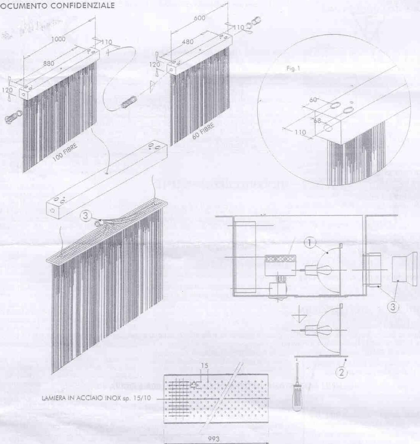
NON APPLICARE L'ILLUMINATORE SU SUPERFICI NORMALMENTE INFIAMMABILI, IN CASO DI FISSAGGIO SU CONTROSOFFITTI ADEGUARE I SOSTEGNI ALLE NECESSITA', RISPETTANDO LE NORME DI SICUREZZA.
